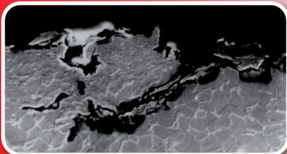
Piqûre de corrosion au microscope
